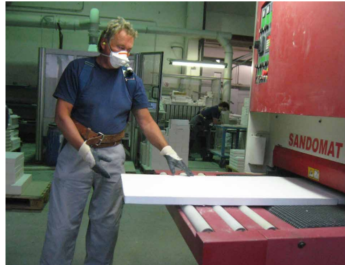
Teilweise geschlossene Schleifmaschine mit Absaugung
